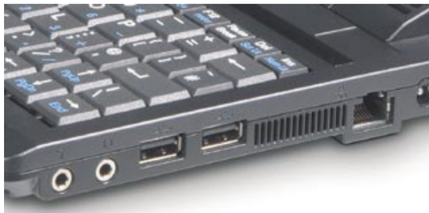
Das UMD EasyNote XS von Packard Bell verfügt über alle wichtigen Schnittstellen wie LAN, WLAN, Bluetooth, DVI, USB 2.0, Line in, Kopfhörer, Mikrofon und 4-in-1 Cardreader.
